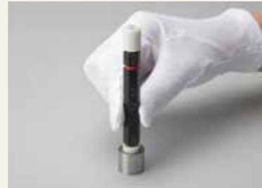
～プラグゲージによる穴検査～ Acceptance judgment
