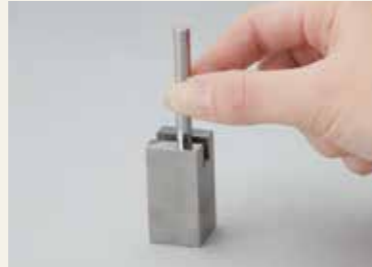
～溝幅の測定～ Width of groove
