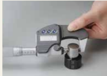
～マイクロメータの校正～ Calibrating micrometers
