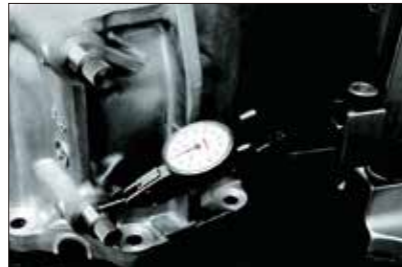
ハイトゲージでねじ穴位置を測定 Measurement with a height gauge
