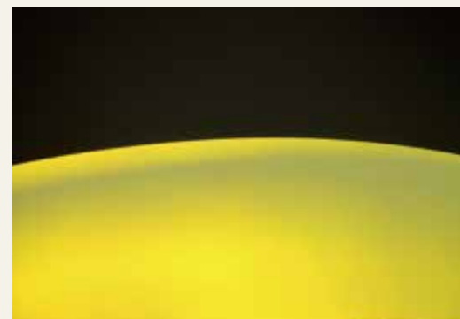
ミュラーバイトの刃先 ×250 The edge of Muller Bite
