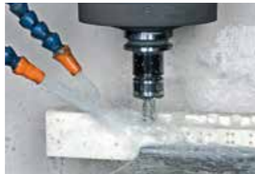
マシニングセンタによるセラミックスの加工 Processing of ceramics by machining center
